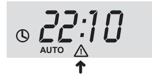
Die Zufallsfunktion ermöglicht eine zufällige Verzögerung der eingestellten Schaltzeiten von 0 bis 30 Minuten.
