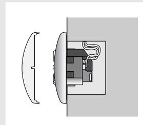
Die Anschlussleitungen werden entsprechend der Klemmenbelegung (Kapitel 2.2) an den Klemmen des Steckrahmens angeschlossen.
